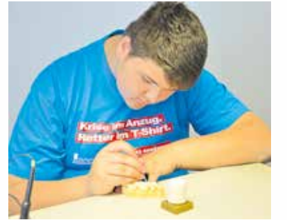
Bei der Bernburger Dentalmanufaktur tropft Jason Wachs auf das Modell und übt sich in Vorarbeiten, die für die Herstellung einer Krone dienen.
