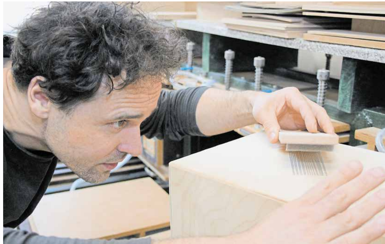
Wichtiger Qualitäts-Check: Markus Meyer überprüft die exakte Montage eines Snareteppich-Segments an der Cajon.
