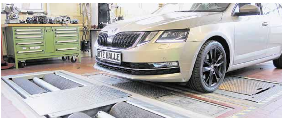
Bremsen sind lebenswichtig. Ob diese funktionieren, wird auf Bremsanlagen geprüft.
